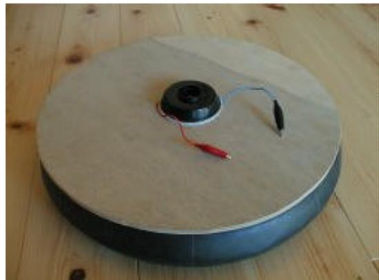
付属のニッカド電池をつないでみると、モーターは「ウィーン」と軽快な音を上げながら回転し、滑走体を床から持ち上げてスルスルと滑り始めました。これはこれで、等速直線運動の授業でエアパック(乾電池式滑走運動体)の代わりに使えそうです。
