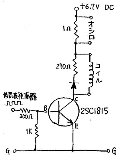
電源は電池で、トランジスタのスイッチングで「△△△△」電圧をコイルにかけるのです。これで電源のインピーダンスの問題は解消します。
