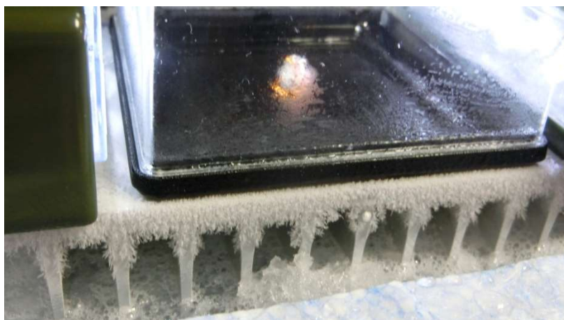
霧箱の下のヒートシンクが凍り付いて霜がついています
