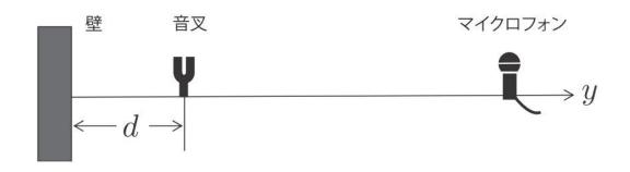
壁とマイクの距離は約130cm, 音叉の振動数は440Hzで, 波長λは約77cmです。
