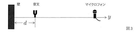
問 4 y軸の正の方向に音叉の位置を少しずつ変えながらマイクロフォンで観測すると、音の強さが周期的に変動した。マイクロフォンで観測された音が強くなるときの、音叉と壁の間の距離 d と音の波長  $\lambda$  との関係を表せ。必要であれば、自然数として n  $(n=1,2,3,\cdots)$  を用いてよい。
